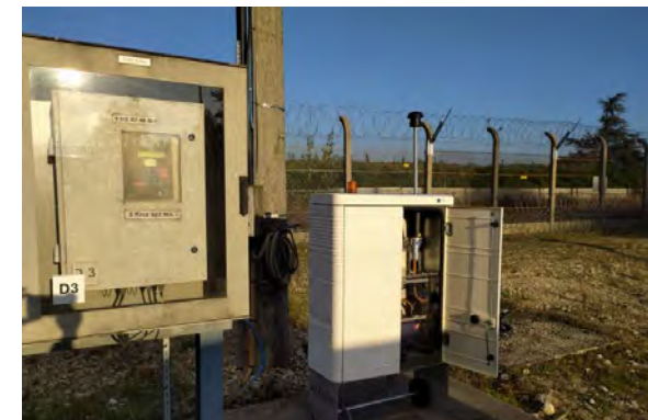
Station AS3 (De gauche à droite) : Balise de mesure radiométrique / préleveur aérosol (EDF)
